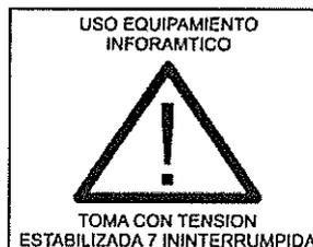
Los circuitos ATE deberán tener como máximo quince (15) bocas, sin limitación de potencia de salida de cada una, tipo de alimentación, ubicación, conexasión o dispositivos a la salida, ni de potencia total del circuito o de valor de la protección. Es responsabilidad del proyectista determinar esas características, cumpliendo lo establecido con carácter general en esta Reglamentación.
