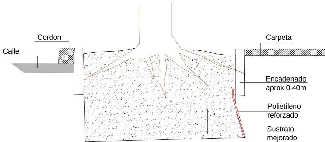
Por sobre todo deben ser lo suficientemente flexibles o modulares para permitir el desarrollo de las raíces superficiales, las cazuelas entonces deben ser ampliadas con el tiempo, y trabajadas con juntas de dilatación inferiores que permitan el desarrollo normal de las raíces sin afectar las construcciones vecinas .
